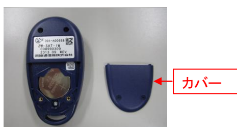
①ネジを取外してカバーを開きます。
