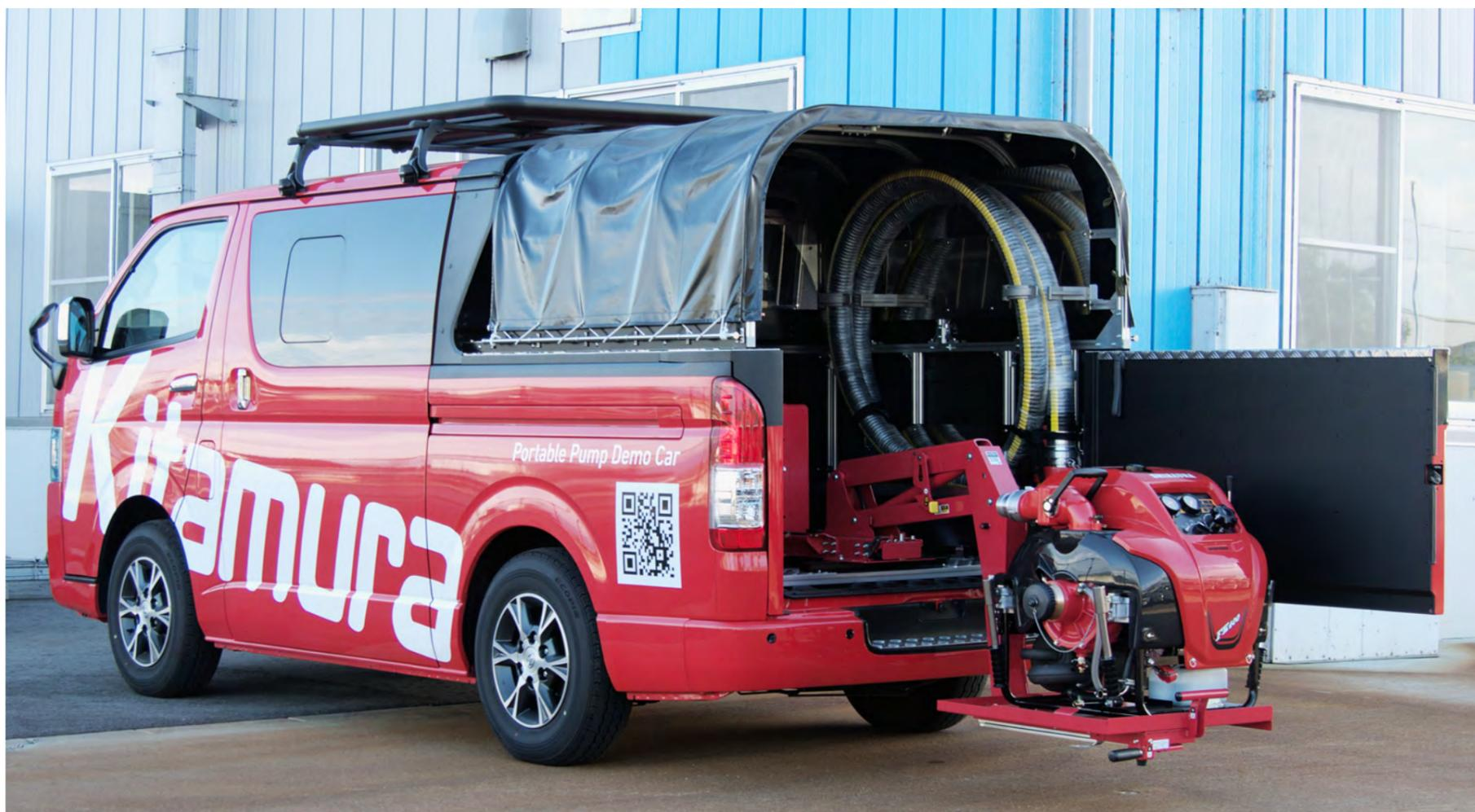
本製品は乗用車をベースとして消防仕様に架装した、新しいタイプの消防車両です。可搬消防ポンプや消火資機材を積載し、ポンプ車よりコンパクトで、軽積載車より積載力・パワーのある車両です。また、普段トラックを運転しない女性でも運転しやすい車両です。
