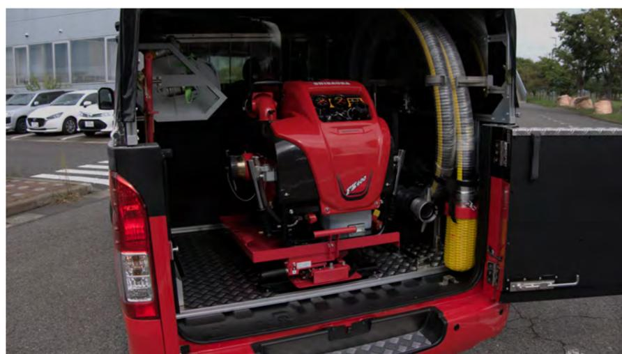
電動油圧式リフターを搭載し、積み下ろしが簡単
