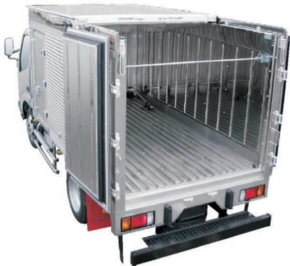
ボデールーフがスライド開閉するバンボデー。車高の低い車両であっても、ルーフドア全開時は腰の負担が少ない直立状態で、荷物の積み降ろしができます。ボデーリア部分に仕切板を設置。リアドアが開いても荷物が落ちない仕様です。積荷にあわせたドライバン仕様も可能です。
