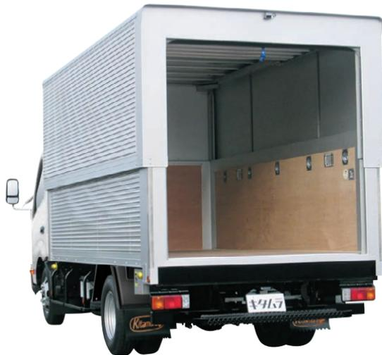
車高の上下調節が自由に行えるバンボデー。積載する荷物の量や、周囲の環境に合わせてボタンで調節が可能。車高制限のある場所の配送に最適です。また車高を高く調節することで、背の高い大型家具、生活器具等の積み降ろしが直立作業で行えます。
