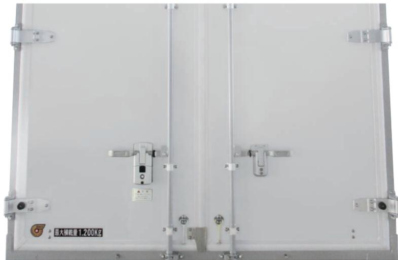
バンボデーの施錠・解錠の利便性とセキュリティを強化した荷役省力化装置。ACCシステム停止機能やバッテリーセーブも行えます。オプション選択で一斉施錠・解錠機能やアンサーバック機能を追加できます。
