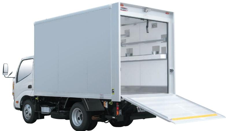
給食の配送業務専用バンボデー。給食センター・学校での積み降ろし条件に対し、オーダーメイド設計・製造で対応。プラットフォームから庫内への給食用コンテナの積み込み・積み降ろしが容易に行えるよう、室内には渡し板、またはリフトを装備。
